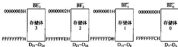
图 5-23 32 位微处理器的存储器组织
