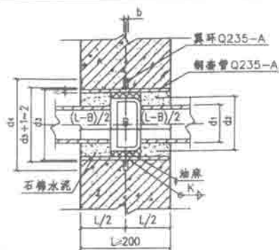
承插管穿钢筋混凝土壁 预埋防水套管
