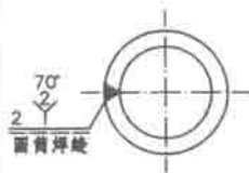
筒顶与侧壁焊接示意图
