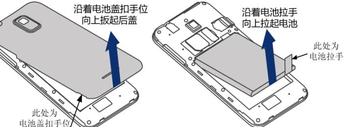
**后盖的拆取：**左手紧握机身侧面；右手在扣手位扳起后盖。
