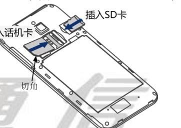
**注意：**请注意保管手机卡，不要弯曲或划伤，也不要接触静电或浸水；手机不支持热插拔，在插拔话机卡和 SD 卡之前，请取下数据线并将手机关机。
