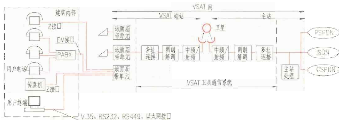
VSAT通信网的基本网络结构
