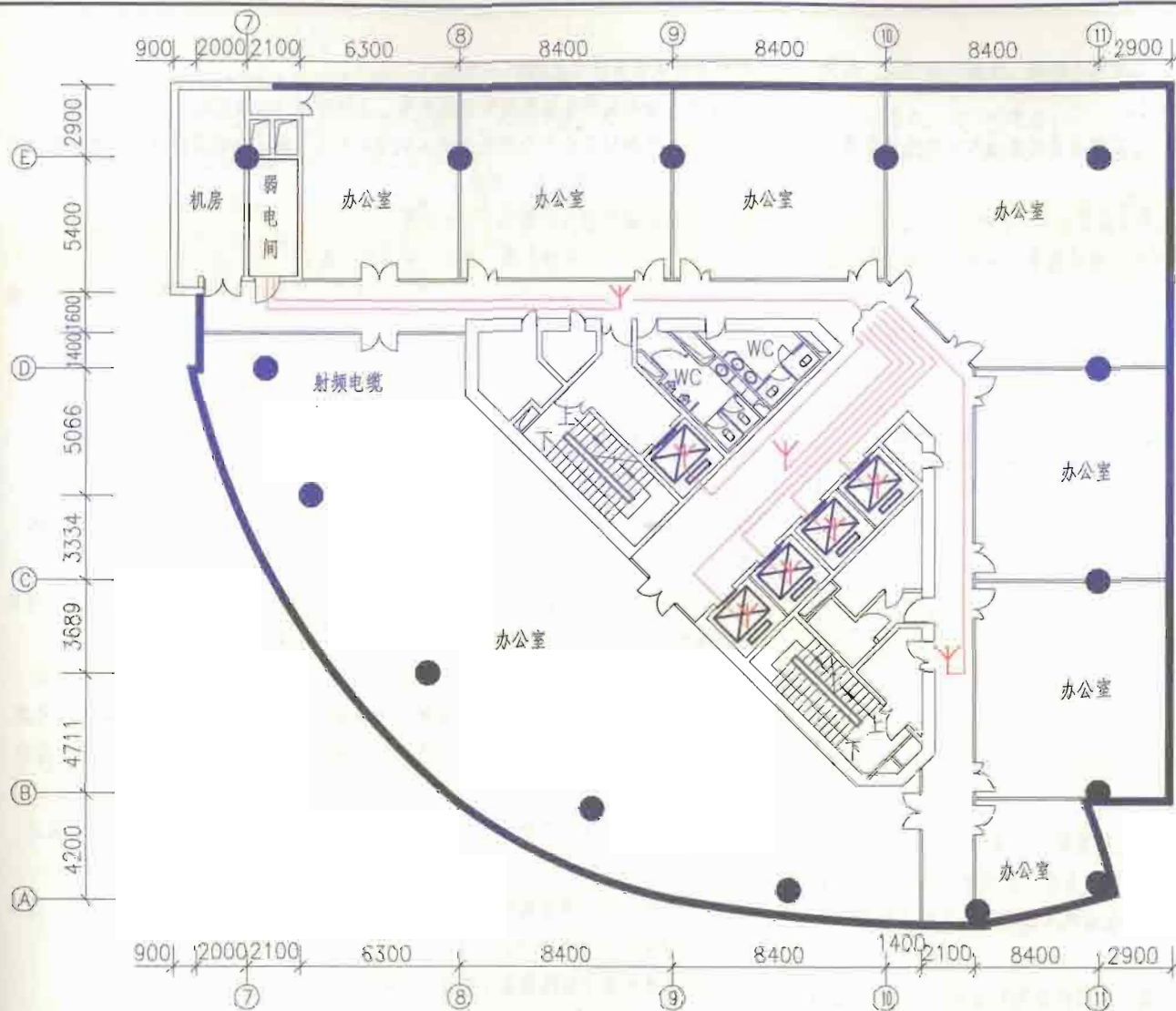
通信系统 移动通信室内信号覆盖平面图示例
